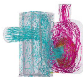
Darstellung des Hydraulik-Flusses in der Pumpe
